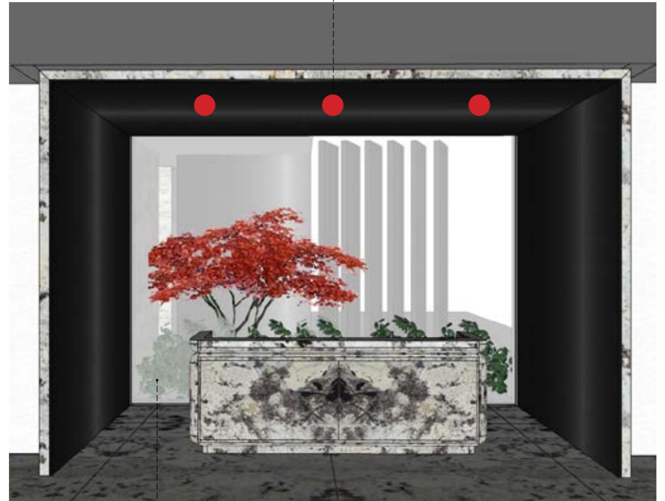
3 PIN LIGHTS OVER RECEPTION DESK. 25MM DIAMETER LIGHT RECESS LIGHT 25MM
