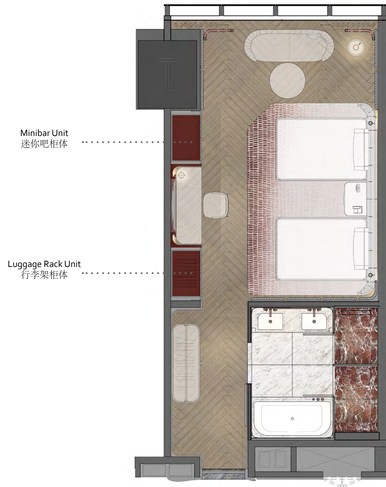
OPTION 2 - TYPE A PLAN 方案二 - A型客房平面图
